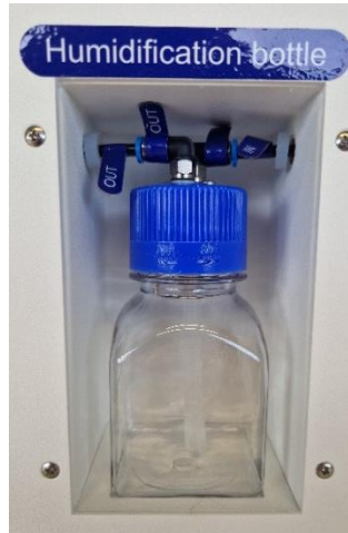
Kuva 22.1 Putkiliitäntä kosteutuspullossa ja Mini MIRI® Humidity-monitila-IVF-inkubaattorissa
