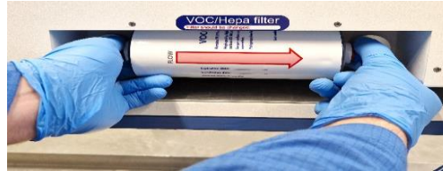
Kuva 12.2 VOC/HEPA-suodattimen asennus- ja poistomenettely
