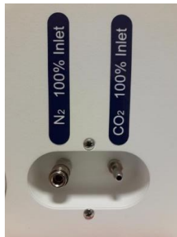
Kuva 11.1 Takana olevat kaasuntuloaukot Mini MIRI® Dry- ja Mini MIRI® Humidity-monitila-IVF-inkubaattoreissa
